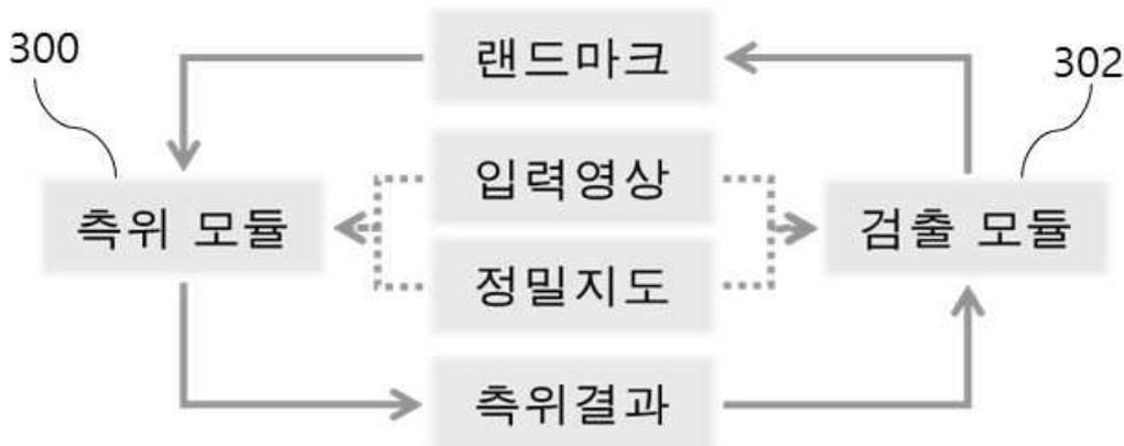
지도를 저수준(low-level)에서 정합하여 상기 이동체의 위치 및 자세를 포함하는 대략적인 측위 결과를 추정하고, 상기 대략적인 측위 결과와 상기 정밀 지도에 저장된 랜드마크의 위치 및 종류를 기반으로 상기 입력 영상 내에서 하나 이상의 랜드마크를 정밀하게 검출하고, 상기 정밀하게 검출된 하나 이상의 랜드마크와 상기 정밀 지도에 저장된 랜드마크를 신경망 모델을 기반으로 정합하여 상기 이동체의 위치 및 자세를 포함하는 정밀한 측위 결과를 산출하도록, 상기 프로세서에 의해 실행 가능한 프로그램 명령어들을 저장하는 상보적 관계 기반 정밀 측위 및 랜드마크 검출 장치가 제공된다.
